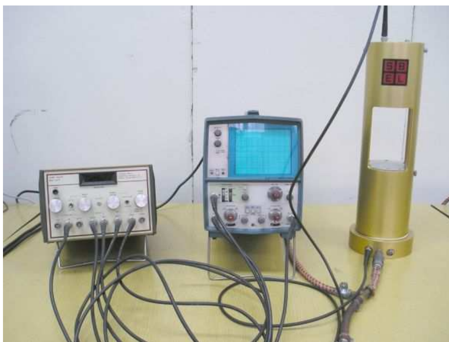
Slika 8.1. Sustav uređaja za mjerenje brzina prolaza ultrazvučnih elastičnih valova
