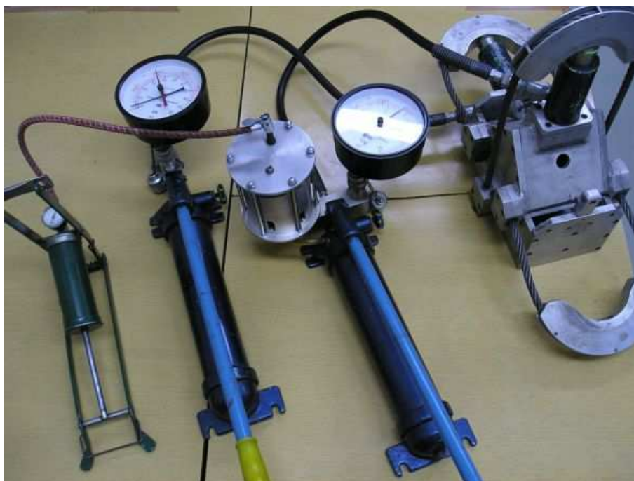
Slika 7.1. Uređaj za direktno smicanje "Robertson Research"
